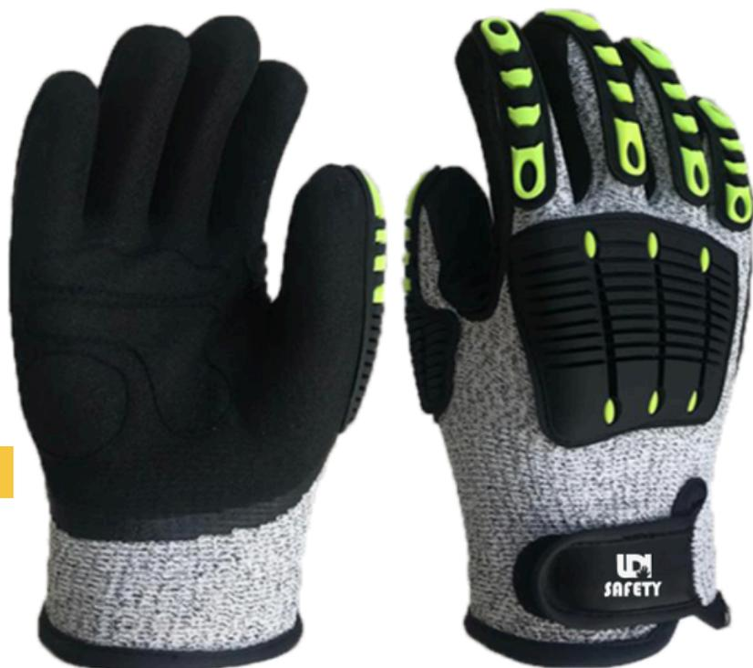
Luva de segurança confeccionada em fibras especiais de alta tenacidade resistente ao corte, revestimento em borracha nitrílica, reforço interno na palma e entre o polegar e indicador, proteção anti-impacto termoplástico no dorso, punho tricotado nas mesmas fibras.
